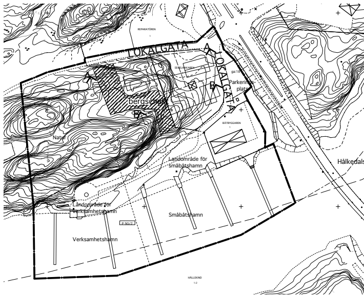
Sektionerna och kartan visar den aktuella släntlutningen genom området samt den planerade utformningen efter uttaget av berg, skala 1:4000
