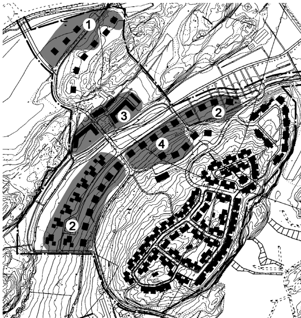
Sammanställning av delområden på plankarta, daterad 2003-01-22. Gråa ytor visar område med planbestämmelser angående grundläggning.
