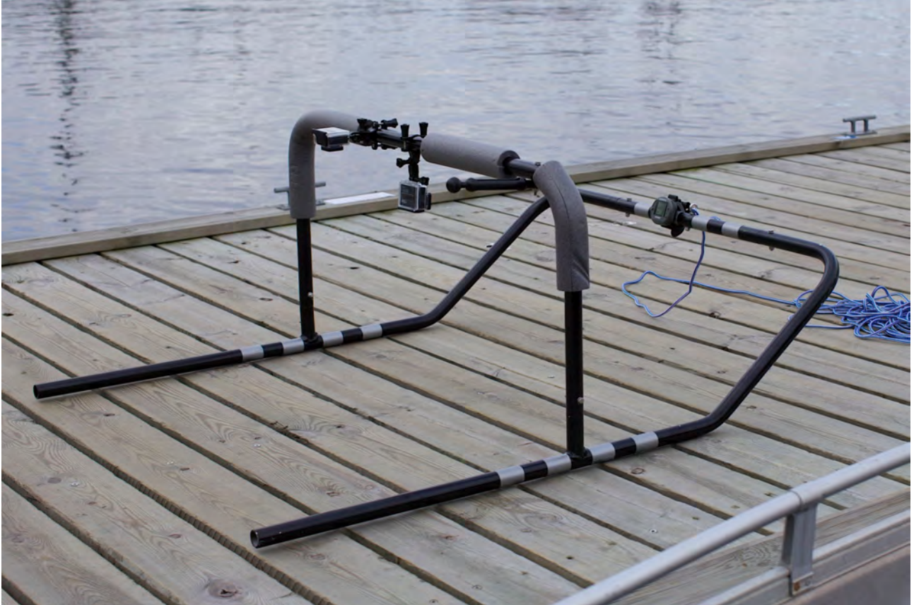
Fig. 1. Den släpande undervattensfarkosten minimally operated underwater vehicle (MOV) utrustad med två kameror.
