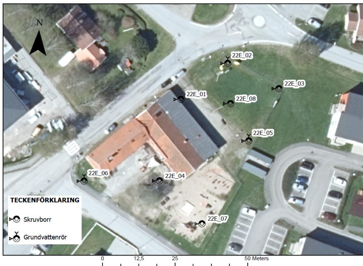
Figur 7. Placering av provpunkter för skruvborrning och grundvattenrör.
