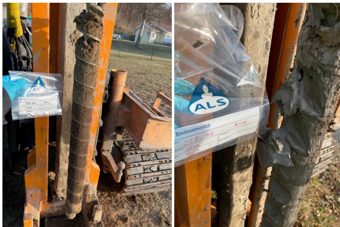
Figur 8. Bilder från provtagning med skrubborr. Bild till vänster visar översta metern för punkt 22E_08. Bild till höger visar lera från punkt 22E_06 vid 3-4 meter under markytan.
