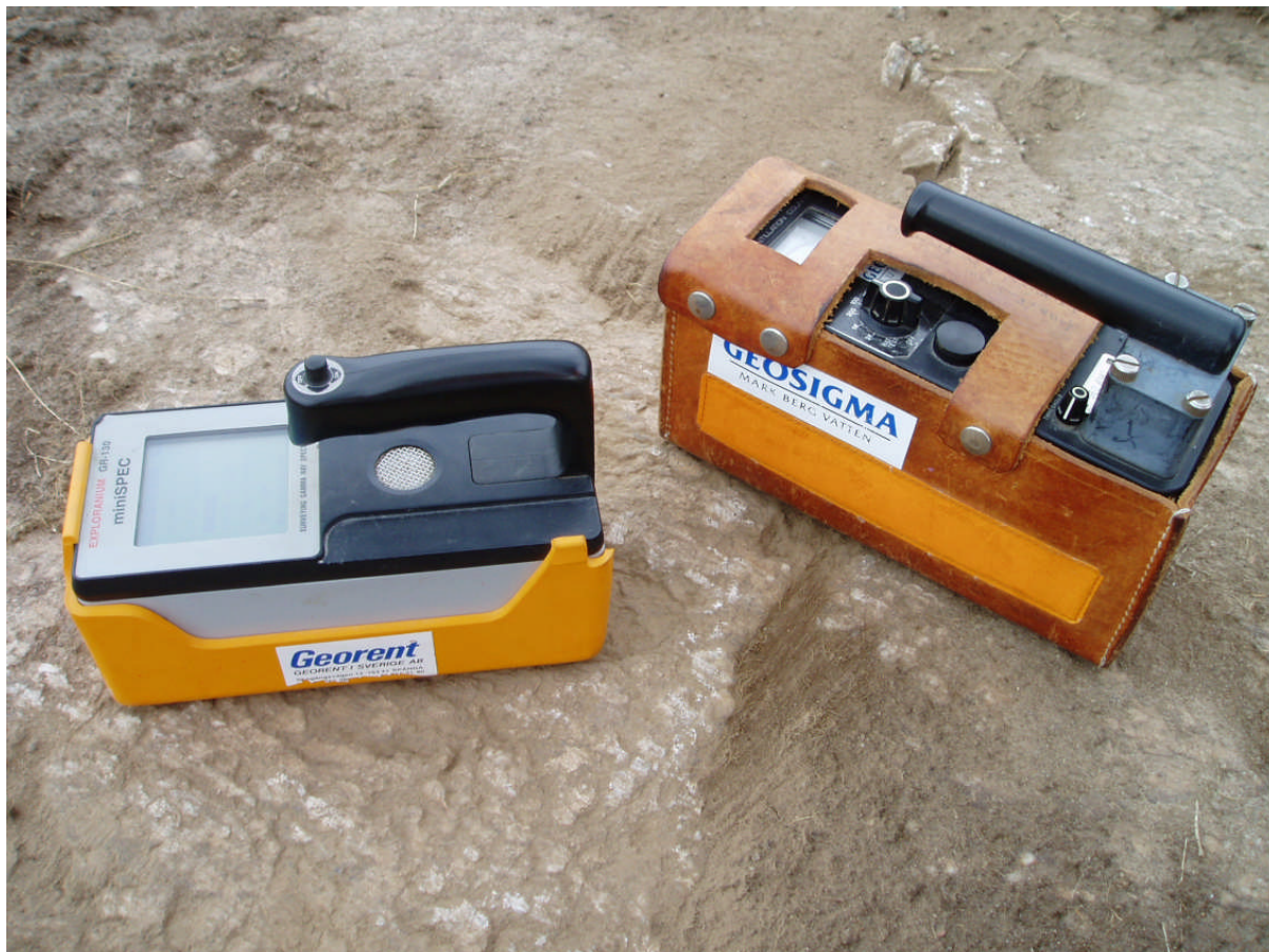
Figur 1. Använd mätutrustning. Gammalspektrometer t.v. och scintillometer t.h.
