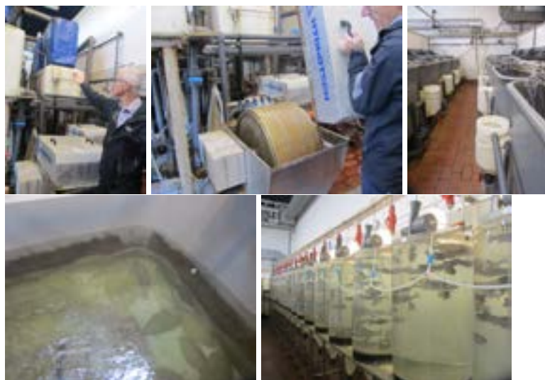
Figur 26. DTU aqua, foton vid studiebesök 2013, sötvatten-RAS. a) Övertäckt avgasningsdel för effektiv koldioxidutgasning, b) mindre trumfilter, c) foderförsök med tillväxt av tunga, d) odlad tunga, e) foderförsök regnbåge. Foto: Anette Ungfors.
