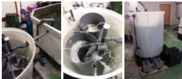
Figur 49. Färdigställande av fiskkar och biofilter med vatten i slutet av maj, under uppstart av biologisk rening. Foto: Ninni Petersson.
