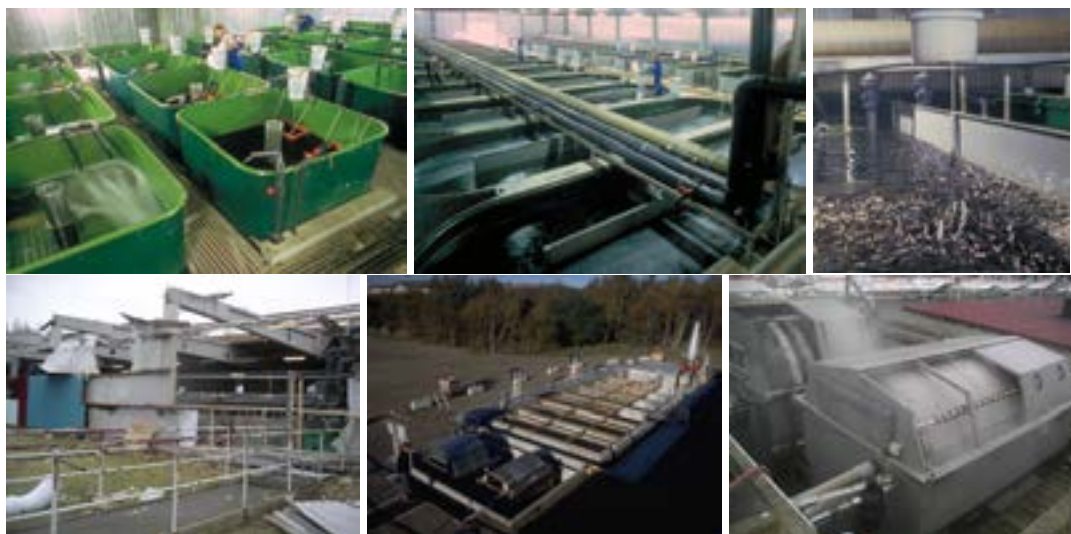
Figur 5. Scandinavian Silver Eel AB anläggning, Helsingborg. A) små ålbassänger, b) stora ålbassänger, c) hoppande ål vid matning d) ålbassängerna i januari 2014 med halltak bortblåst från höststorm i november 2013, e) reningsteknik stora systemet: mekaniska filter, biofiltermaterial i bassänger samt syrekon, f) trum-och skivfilter. Foton från Richard F, SSE.
