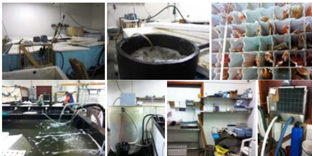
Figur 14. Fotosession fortsatt utveckling av anläggningen. a) virrvarr av kräftkar 2010-2012, b) proteinskummare, c) kräftkassett, d) 2012, specialproducerad ny stor bassäng 18 m 3 som ersätter alla småkar, e) ett av de två biofiltren fyllda med Anoxkaldnes biomaterial, f) labanalyshörnan, g) kylare. Foto: Anette Ungfors.
