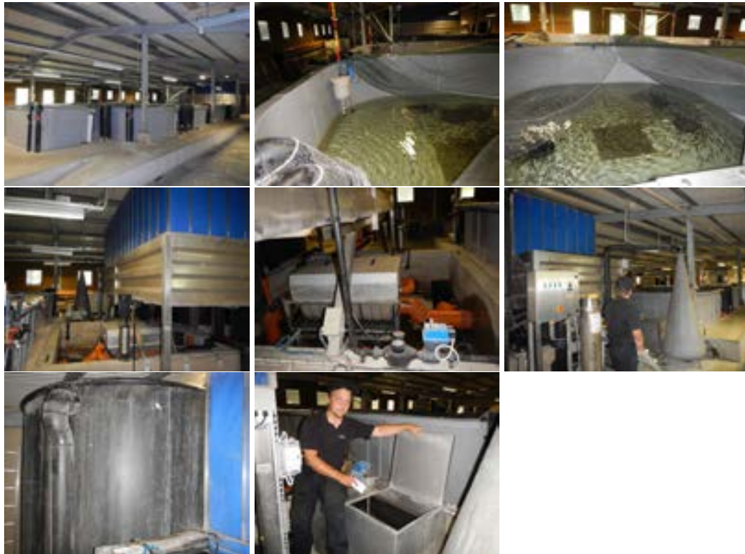
Figur 11. RAS 2 med upp till 1 + -åringar. a) Översikt lokalen med 8 större fisk-kar plus 2 st. mindre kar för t.ex. ph-stabilisering med natriumkarbonat, b) 5 x 5 m kar med syrevakt (blå), c) öringar i kar, d) översikt reningsutrustning, avgasning i förgrunden, e) mekaniskt filter, f) syrekon, g) fast biofilter, g) kalk-blandare. Foto: Anette Ungfors.
