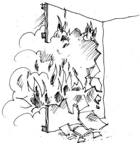
Figur 9. Exempel på dåligt brandmotstånd med nedfallande delar och risk för brandspridning.
